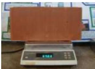
Figura 3 - Pesagem de um bloco para ensaio de absorção.
