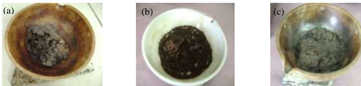
Figura 2 – Imagens das ferritas obtidas após combustão utilizando (a) ácido cítrico (FAC), (b) anilina (FAN) e (c) a mistura (FACAN).
