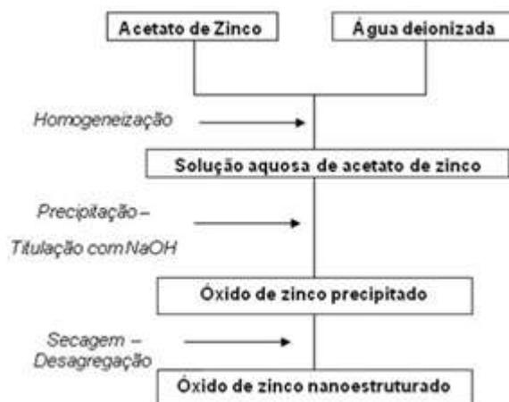
Figura 3 – Fluxograma do procedimento utilizado na síntese por precipitação do ZnO.
