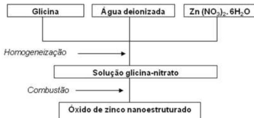
**Figura 2- Fluxograma da síntese de óxido de zinco por combustão em solução de glicina-nitrato em água.**
