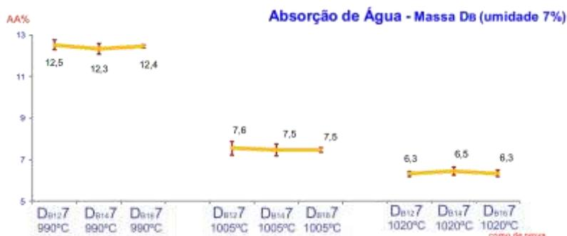
Figura 9 – Absorção de água da massa  $D_B$  com 7% de umidade.
