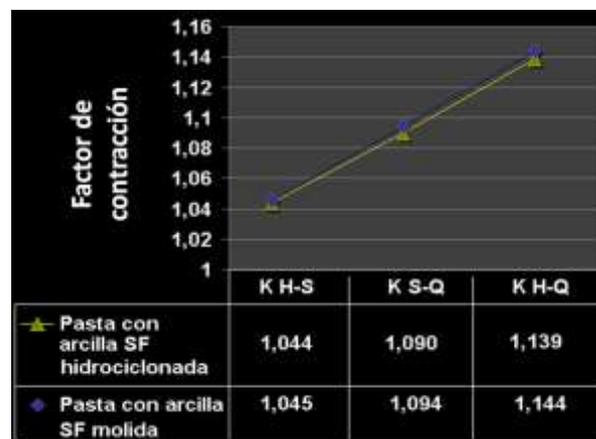
**FIGURA 3.** Factores de contracción para la pasta ensamblada con la arcilla SF hidrociclada y molida.
