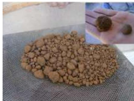
Figura 7: Peneiramento e grumos de cimento e solo.
