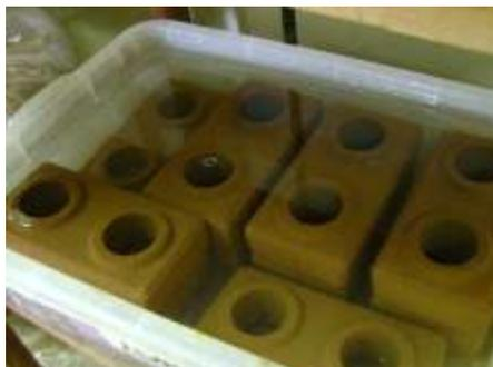
Figura 11: Blocos imersos em água para cura de 28 dias. (Próprio autor)
