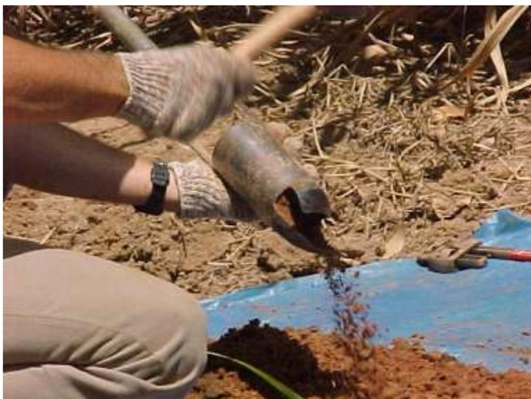
Figura 1 – Material argiloso sendo retirado do trado tipo caneca utilizado na amostragem.
