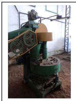
**Figura 12: Compactador automático bloco com dois furos. [Fonte: Própria]**
