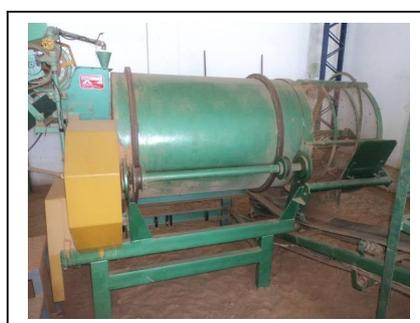
**Figura 9: Misturador Solo-cimento-água**
