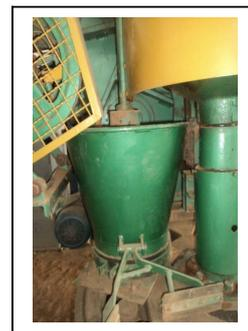
**Figura 13: Detalhe do dosador da mistura solo-cimento.[Fonte: Própria]**
