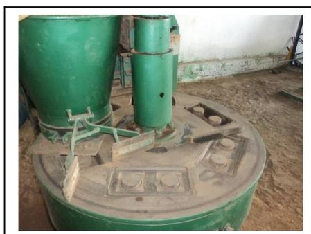
**Figura 14: Detalhe das fôrmas do compactador. [Fonte: Própria]**
