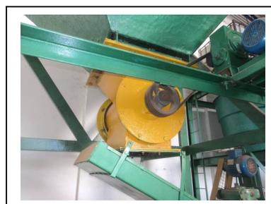
**Figura 5: Detalhe do dosador do Silo. [Fonte: Própria]**
