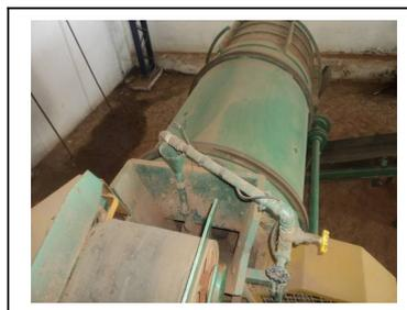
**Figura 11: Detalhe abastecimento de água para o misturador** [Fonte: Própria]
