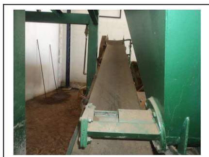
**Figura 8: Detalhe esteira com dosador de cimento.** [Fonte: Própria].
