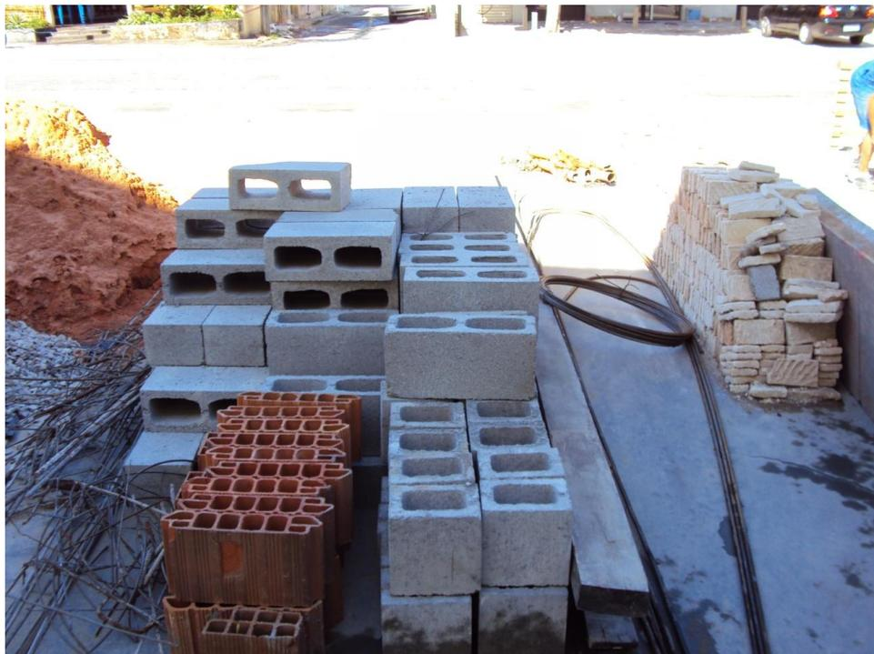
Figura 7. Materiais cerâmicos como bloco de cimento, tijolo branco e PM para laje de cerâmica vermelha. *Fonte: Própria.*
