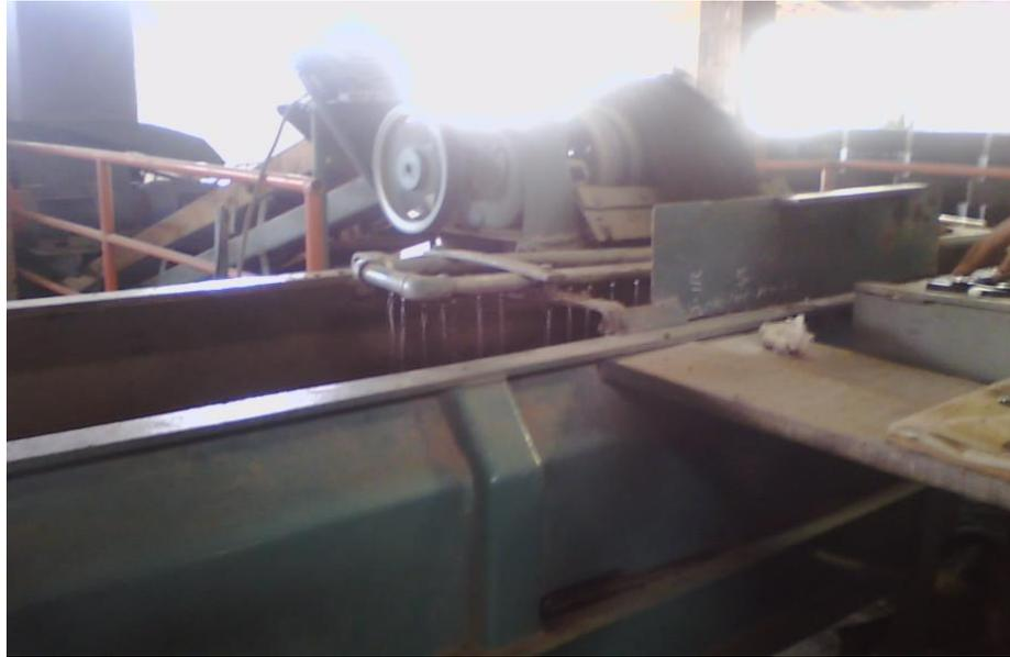
Figura 2. Misturador de Argila. Fonte: Própria, 2010
