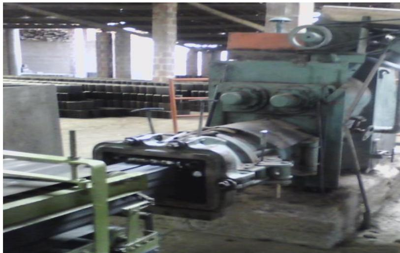
Figura 3. Maromba à Vácuo. Fonte: Própria, 2010
