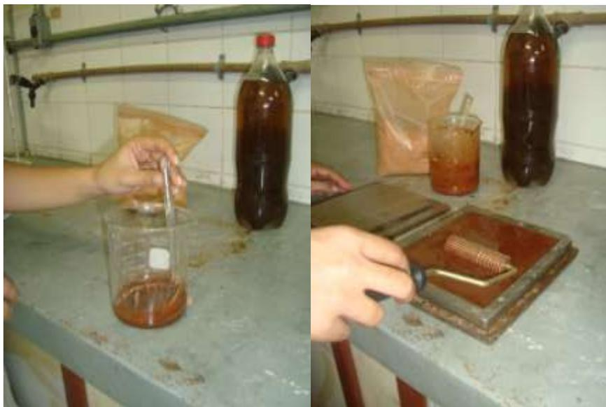
Figura 3 – Mistura da argila com a resina e catalisador e vertida no molde.
