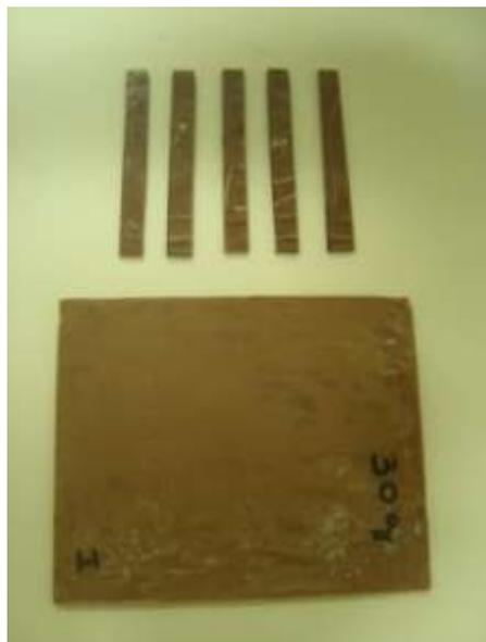
Figura 6 – fotos da placa e corpos-de prova do ensaio de flexão.
