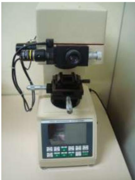
Figura 8 – Microdurômetro digital.
