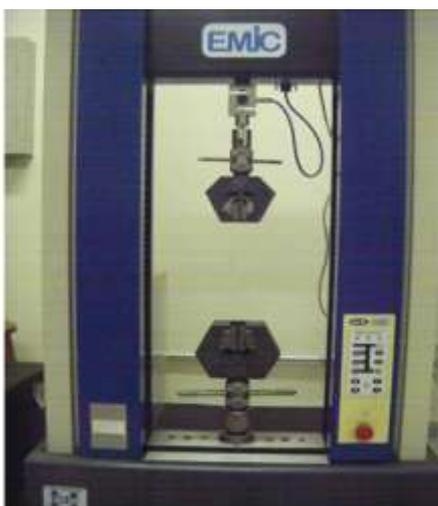
Figura 7 – Máquina universal de Ensaios.
