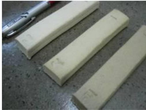
Figura 2. Corpos de prova sinterizados.
