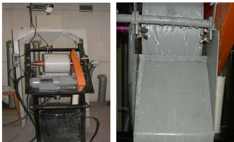
Figura 2. Separador magnético a úmido.
