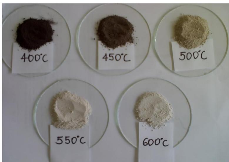
**Figura 1 - Amostras do lodo calcinado a diferentes temperaturas.**
