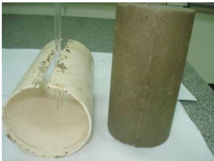
**Figura 2:** Molde de PVC e corpo de prova.
