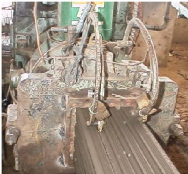
**Figura 7** – Carimbo que é realizado através desta máquina
