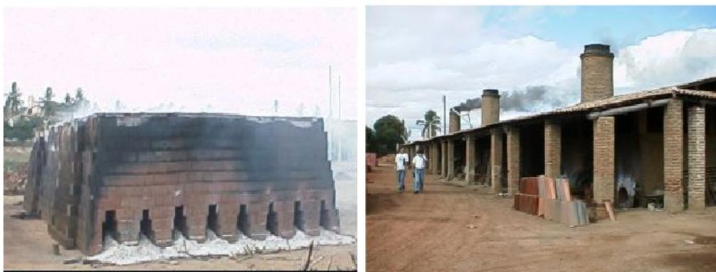
**Figuras 10 e 11** – Modelos de fornos utilizados no RN ( Caieira e Corujinha respectivamente).
