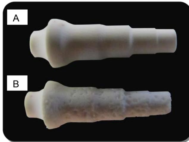
Figura 9 – Pino dentário sinterizado em (A) denso, (B) com gradiente funcional de porosidade.
