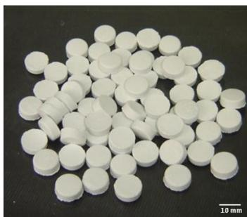
Figura 1: Amostras produzidas a partir da moldagem de suspensões de fases de cimento de aluminato de cálcio.
