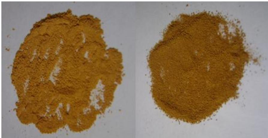
**Figura 1.** Pigmento de Ferro, calcinada a 900 e 1100°C, respectivamente.
