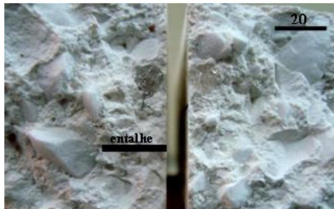
Figura 2 - Fotografia da superfície de fratura de um concreto refratário com agregados de até 22 mm, com um entalhe simulado.
