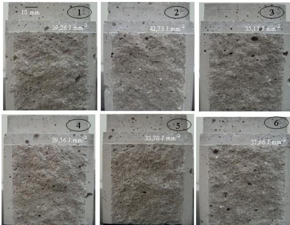
Figura 5 - Fotografia das amostras de argamassa 2:1, mostrando a superfície de fratura, com indicação das respectivas energias de fratura. Os números apresentados nas elipses correspondem às curvas da Figura 4(b).
