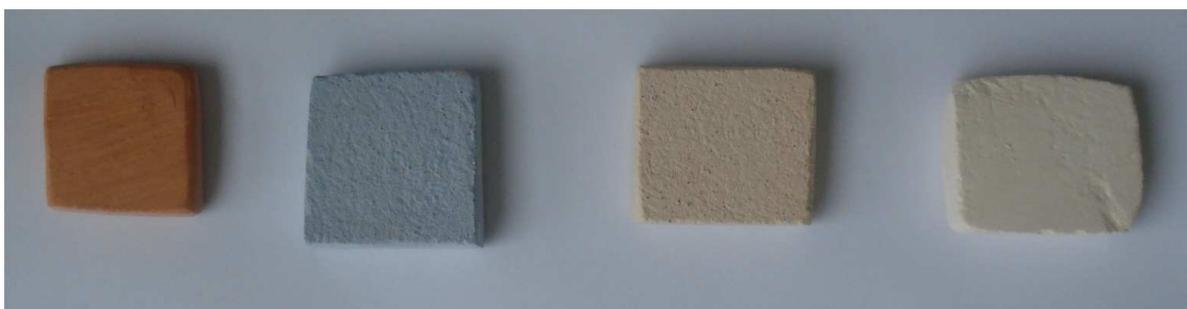
Figura 8: Amostras de argilas após a queima. Na seqüência: Vermelha, Azul, Branca e Paper Clay.
