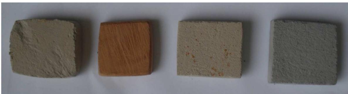
Figura 7: Amostras de argilas antes da queima. Na seqüência: Paper Clay, Vermelha, Branca e Azul.
