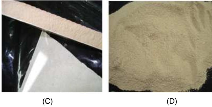
Figura 2: resíduo porcelanato esmaltado in natura(C ) e após moagem no britador de rolos (D).
