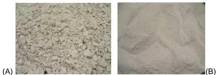
Figura 1: resíduo porcelanato polido após moagem no britador de rolos (A) resíduo porcelanato após passagem no pulverizador de disco (B).
