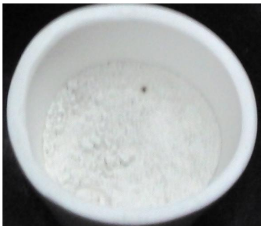
Figura 4: Imagem da mistura preparada (Resíduo de granito, areia e carbonatos de sódio e cálcio).
