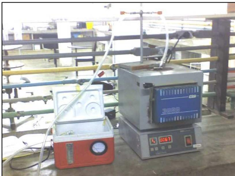
**Figura 1** - Sistema de amostragem completo dos aldeídos.
