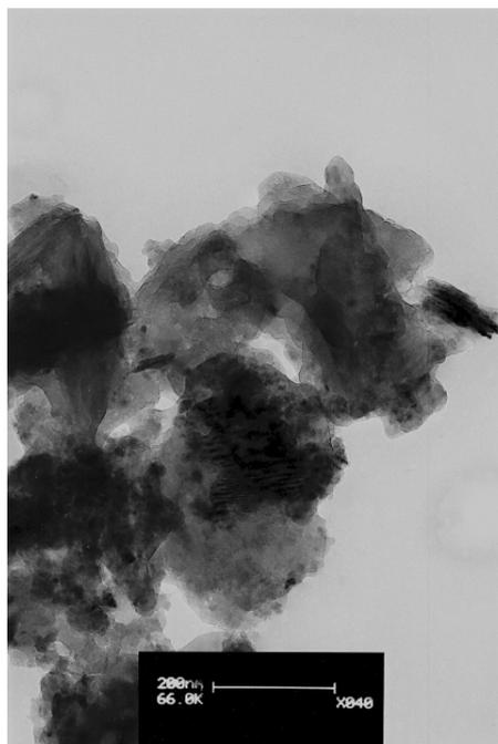
Figura 5 b – Imagem de MET da lama vermelha com tratamento térmico: 800°C
