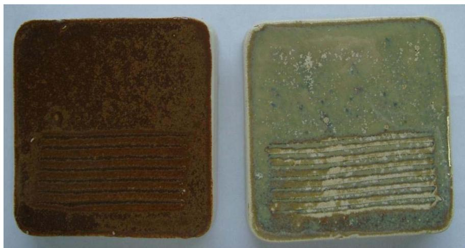
Corpos de prova respectivamente V1RA1 com 22,84% de rejeito de ardósia e V1RA2 com 12,42%
