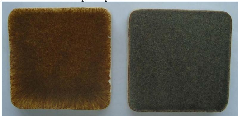
Corpos de prova respectivamente V3RA1 com 39,79% de rejeito de ardósia e V3RA2 com 19,9%.
