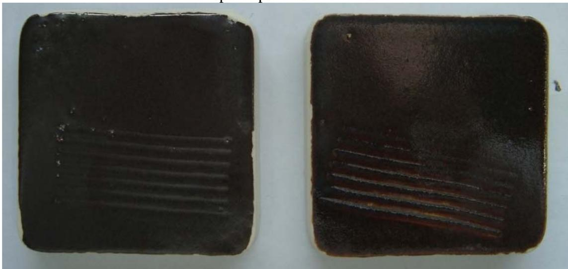
Corpos de prova respectivamente V2RA1 com 70,78% de rejeito de ardósia e V2RA2 com 39,92%
