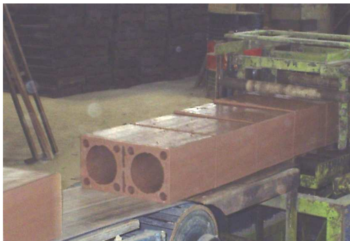
Figura 4 – Blocos estruturais fabricados com a mistura LV-Argila
