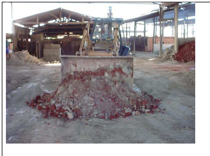
Figura 2. – Mistura de LV-Argila com carregadeira hidráulica. Na cerâmica Barbosa
