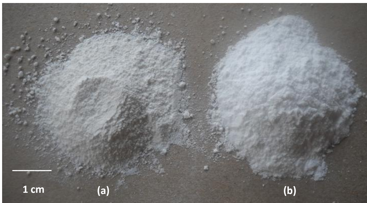
Figura 5 - Fotografia da casca de ovo de avestruz moída: (a) antes da calcinação e (b) depois da calcinação.
