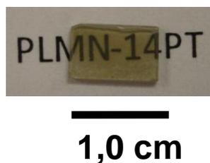
Figura 5. Exemplo típico de uma cerâmica ferroelétrica de PLMN-14PT, polida opticamente após prensagem a quente, com espessura de 630 μm.
