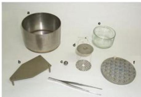
Figura 1 - Acessórios utilizados na medida de densidade. a) plataforma, b) cesta, c) porta pastilhas, d) esfera, e) recipiente para impregnação, f) recipiente de vidro.
