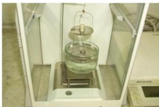
Figura 3 - Montagem do suporte, cesta e recipiente de vidro colocado sobre o prato da balança.
