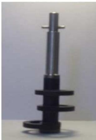
**Figura 3.** Fotografia da haste do tipo Discos Excêntricos.
