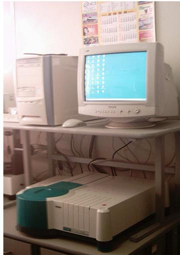
**Figura 4.** Fotografia de um espectrofotômetro.
