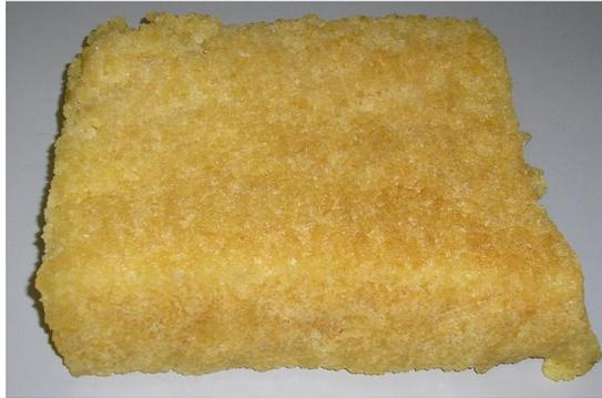
**Figura 1.** Fotografia de uma amostra de borracha seca (Crepe Claro Brasileiro) utilizada para preparação dos nanocompósitos.
