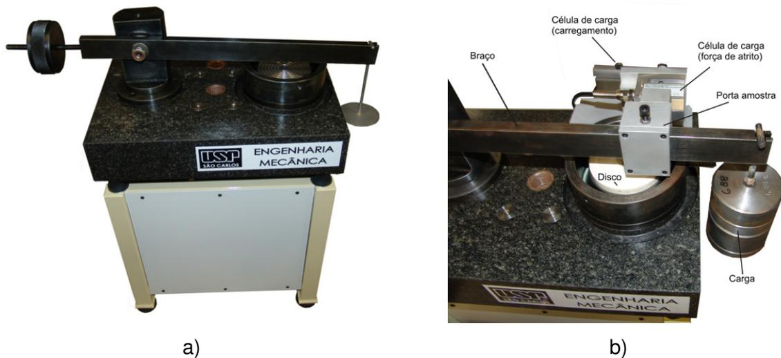
Figura 5 – Protótipo montado, em a) o protótipo em fase final e em detalhe das células de carga,
