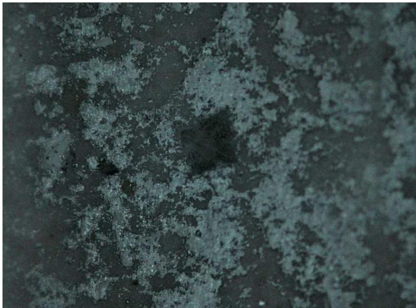
Fig. 3. Microscopia Óptica da cerâmica  $\text{Ca}_2\text{AlWO}_{5,5}$ , após o polimento, mostrando a indentaçãõ do Ensaio de Dureza Vicker's (magnificaçãõ 200x).
