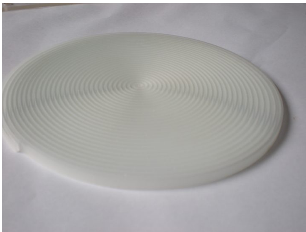
Figura 1 Espiral cortada com jato de água de ultra-alta pressão em lâmina de vidro de 10 mm de espessura
