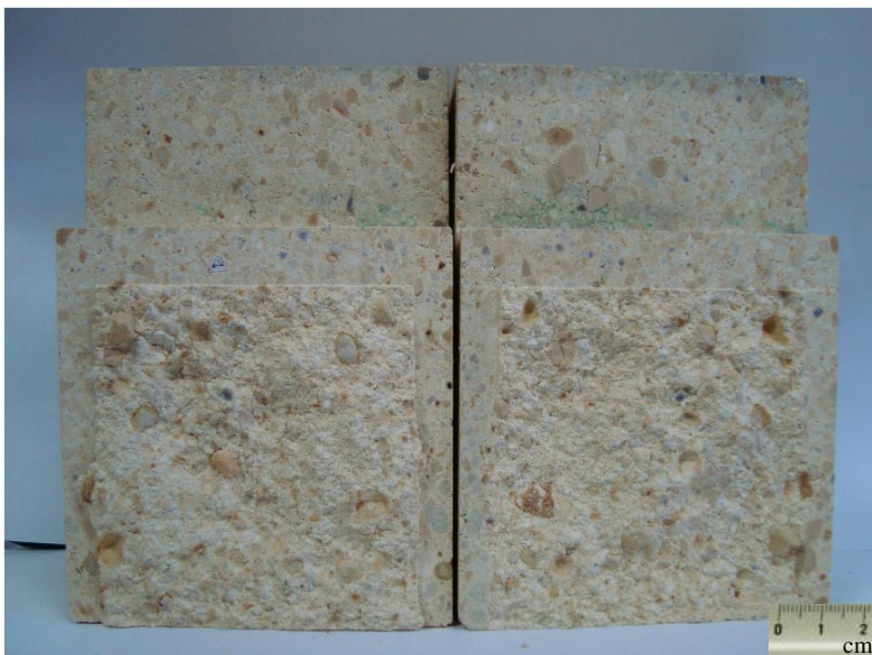
Figura 4 – Superfície de fratura de uma amostra de tijolo refratário
