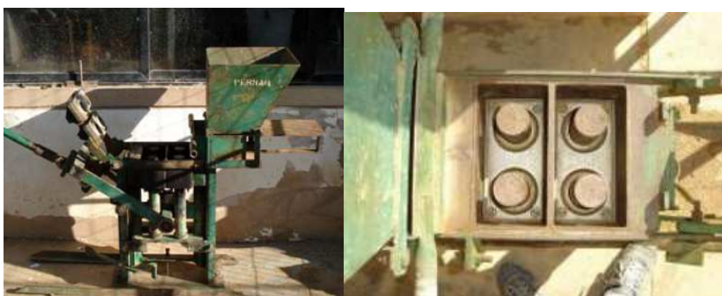
Figura 1 – Prensa manual do tipo MTS-10 (vista lateral e superior).
