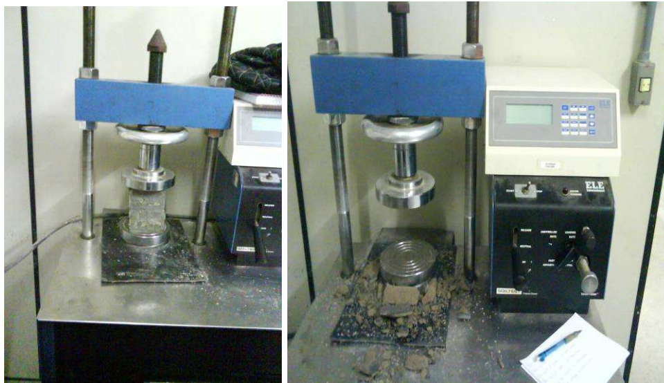
Figura 3 – Ensaio de resistência à compressão
