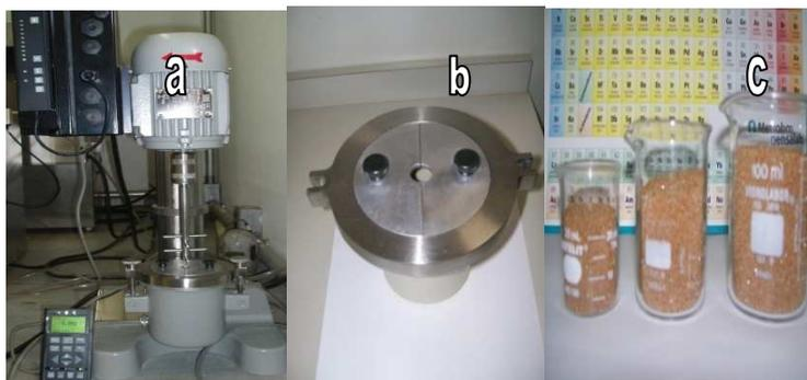
**Figura 1.** (a) Fotografia do moinho atritor com a haste do tipo Molinex, utilizada na moagem, encaixada (b) Câmara de zircônio e (c) bolas de zircônio preenchendo béqueres de vidro.
