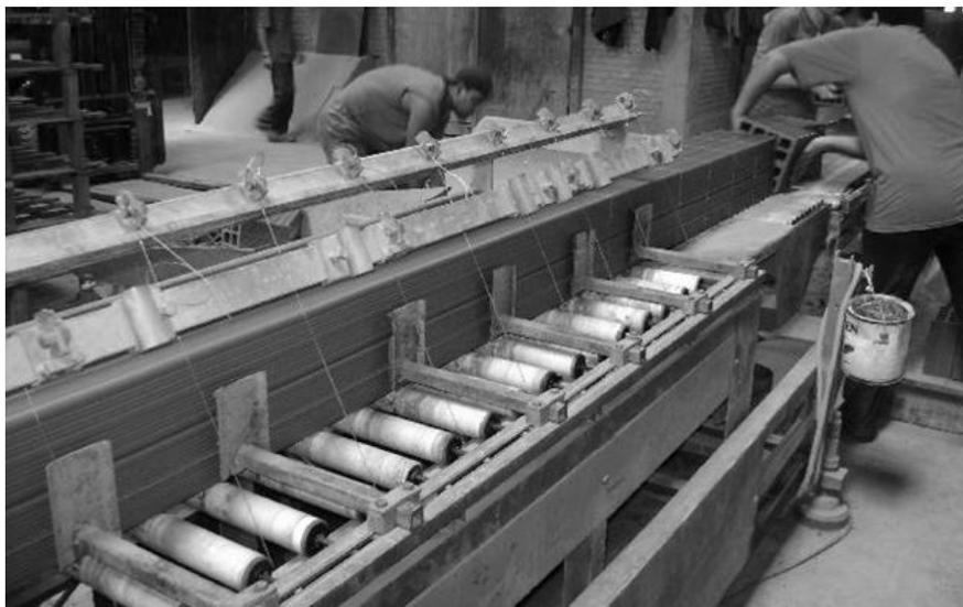
Figura 6. Extrusão e corte dos tijolos.
