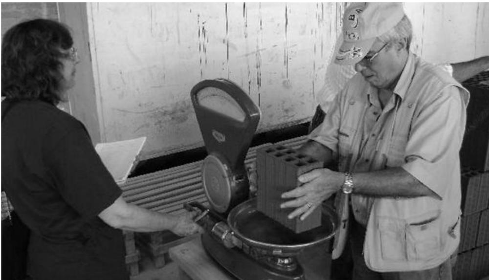
Fig. 8 Pesagem dos tijolos do teste antes de secar e queimar a 700 – 900 °C.
