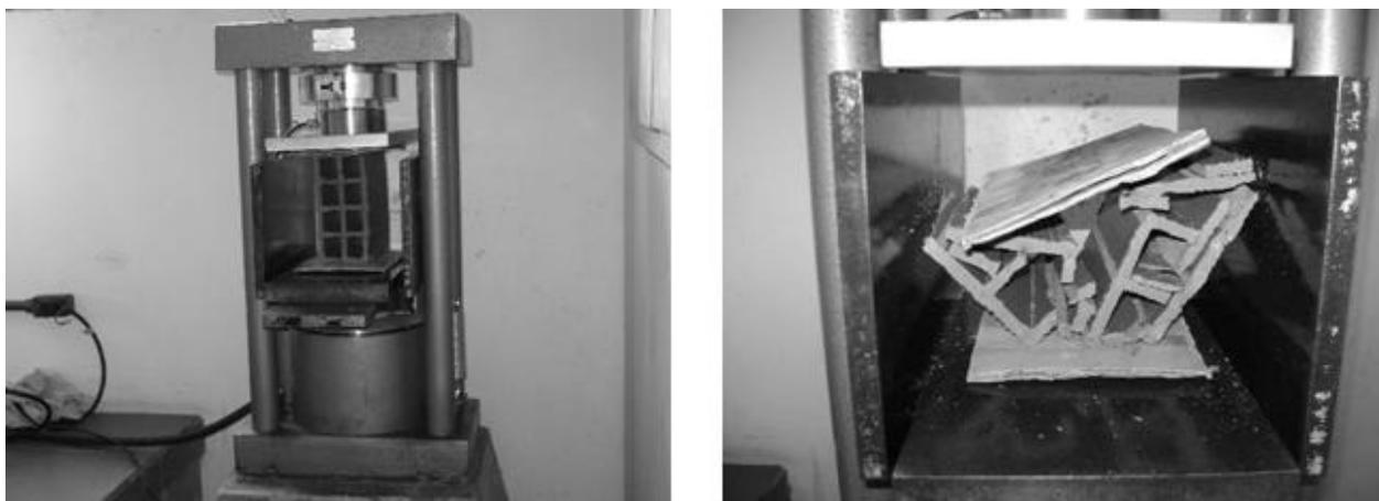
Figura 11. Ensaio de resistência a compressão, início e fim.
