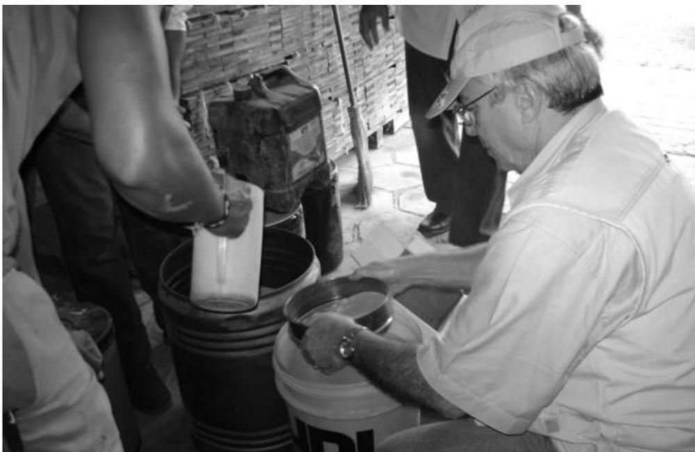
Figura 2. Preparação por peneiramento das areias para o teste de extrusão.
