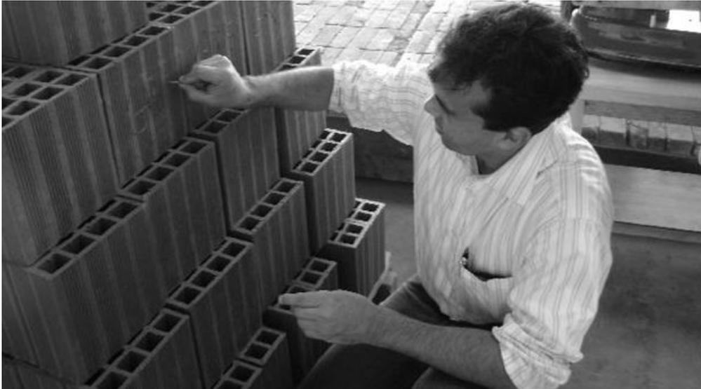
Figura 7. Marcado dos tijolos para identificação posterior.
