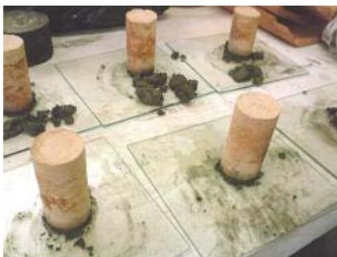
**FIGURA 1** - Corpos de prova utilizados no ensaio de resistência mecânica.
