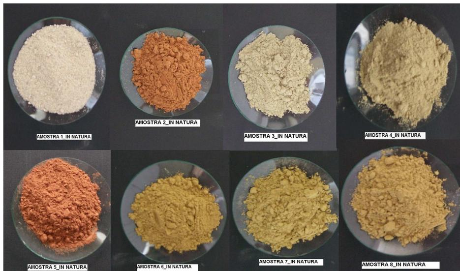
Figura 2 - Amostras in natura pulverizadas e homogeneizadas
