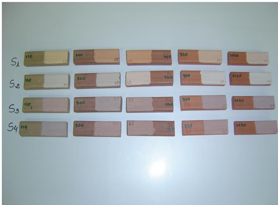
Figura 3: Apresentam os corpos de prova pintados com os pigmentos naturais (engobe) a 110 °C e queimados a diferentes temperaturas (500, 750, 950 e 1050 °C).
