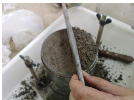
Figura 4 – Confeção dos corpos de prova.
