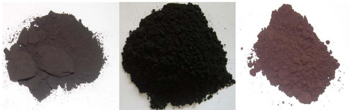
Figura 3. Corante referência, com lodo Fe.Cr e com lodo Ni.Cr.
