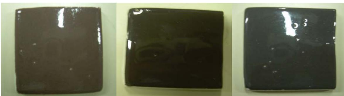
Figura 5. Corpos de prova queimados em 1150°C.
