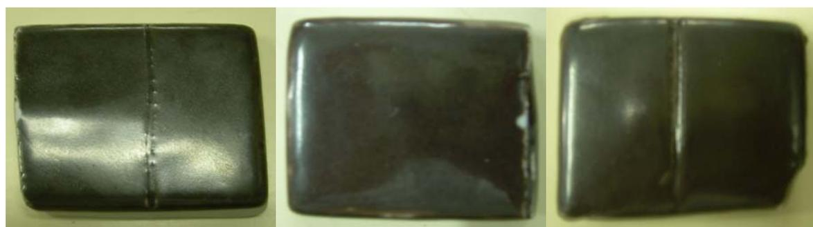
Figura 6. Corpos de prova queimados em 1300°C.
