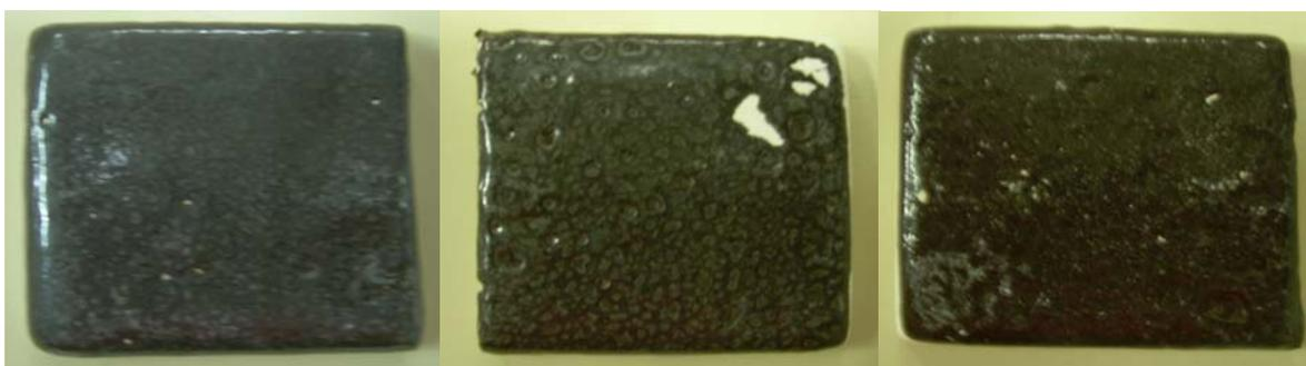
Figura 4. Corpos de prova queimados em 1000°C.
