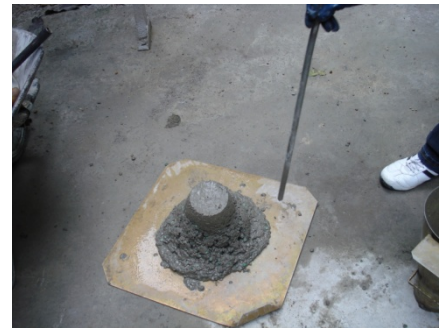
Figura 5- Verificação da trabalhabilidade e teor de água.
