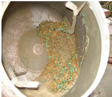
Figura 3- Traço com pet executado em Betoneira.
