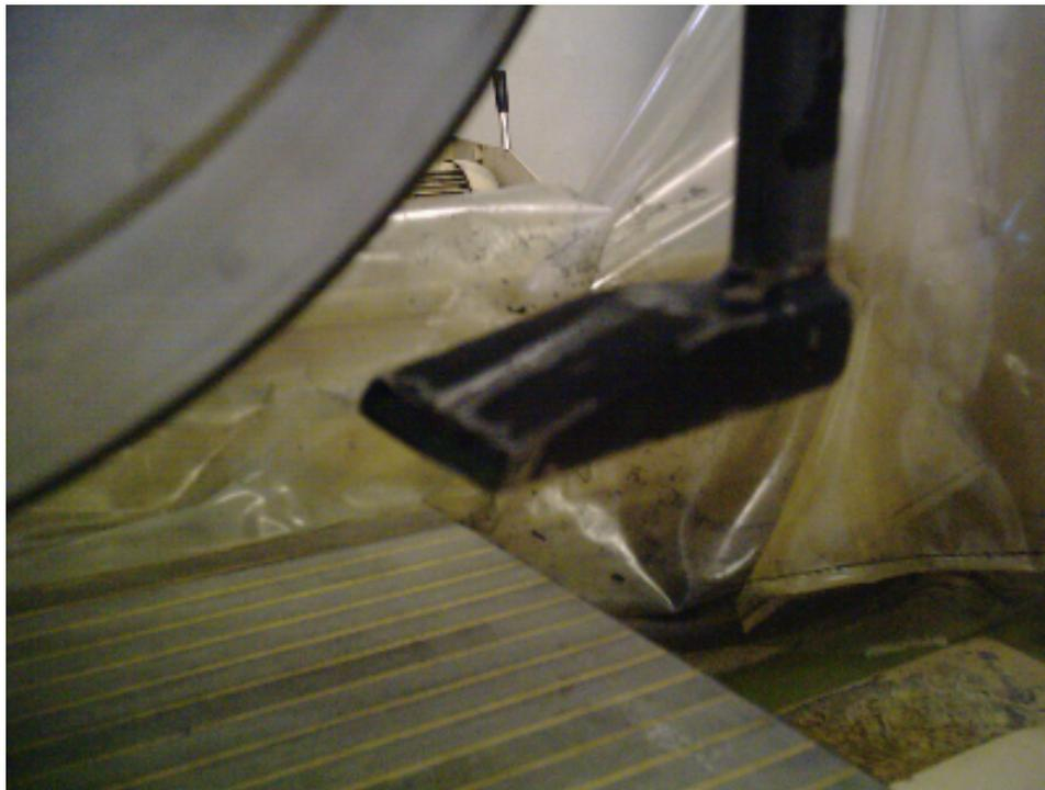
Figura 1 – Visualização da retificação através de lubri-refrigeração com bocal convencional.
