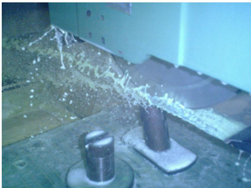
Figura 2 – Operação de perfilamento do rebolo.
