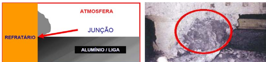
Figura 1. Ilustração da região de um forno de fusão denominada belly band (3) , indicada pela seta, e um caso real da formação de coríndon externo (2) .
