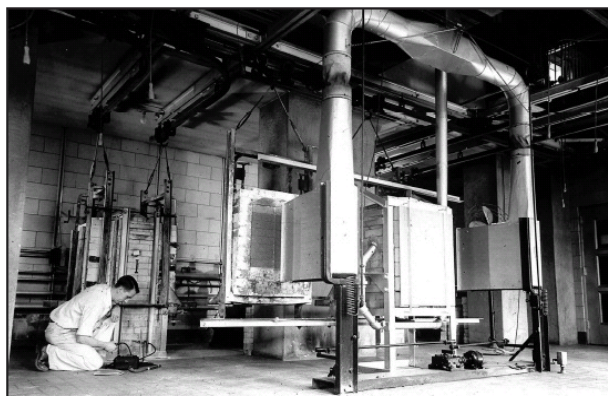
Fig. 3: Equipamento para Panel Spalling tests (3) .
