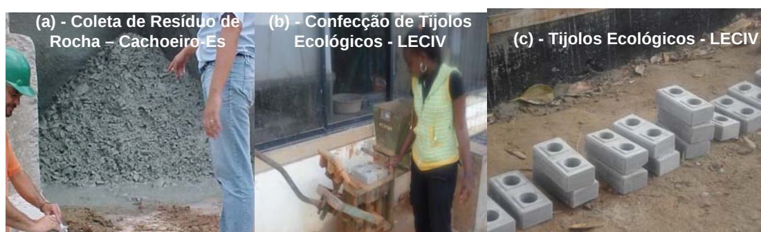
Figura 3 - Etapas da confecção do tijolo ecológico com resíduo de rocha ornamental: (a) coleta, (b) confecção de tijolos e (c) tijolos após cura.
