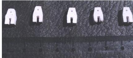
Figura 5. Guia-fios sinterizados a 1650<sup>o</sup>C.
