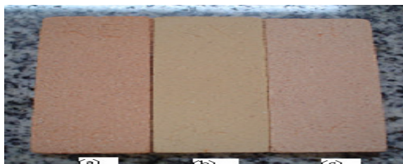
Figura 3 – Coloração dos corpos de prova das amostras RE (a), RX (b) e RH (c) após a queima.
